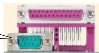
Dans une liaison en série, les données sont envoyées bit par bit sur la voie de transmission. Toutefois, étant donné que la plupart des processeurs traitent les informations de façon parallèle, il s'agit de transformer des données arrivant de façon parallèle en données en série au niveau de l'émetteur, et inversement au niveau du récepteur. Ces opérations sont réalisées grâce à un contrôleur de communication (la plupart du temps **une puce UART, Universal Asynchronous Receiver Transmitter**)
